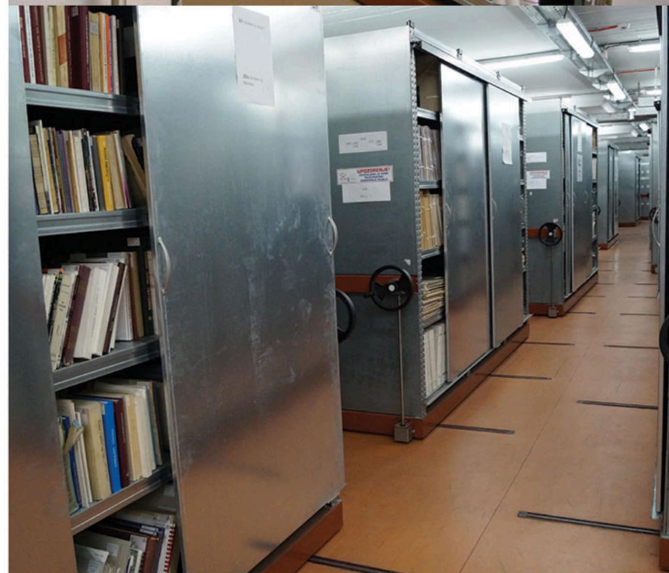
В новом запаснике установлено около десяти километров металлических стеллажей в компактном (передвижном) расположении
