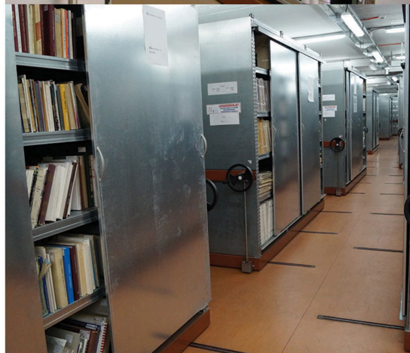
У новом магацину постављено је укупно двадесет километара металних полица у компактном (покретном) смештају
